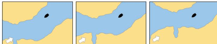
Если выбран режим относительного движения (Relative), местоположение судна фиксируется на экране, а изображение карты смещается относительно своего судна. Чтобы определить, зафиксировано ли изображение судна в центре окна (смещение 0) или смещено на 1/3 или 2/3, можно открыть пункт меню **MENU > Chart Setup > Vessel Offset (МЕНЮ > Настройка карты > Смещение судна)**. При изменении настройки величины смещения на 1/3 или 2/3 видимая область впереди своего судна увеличивается.
