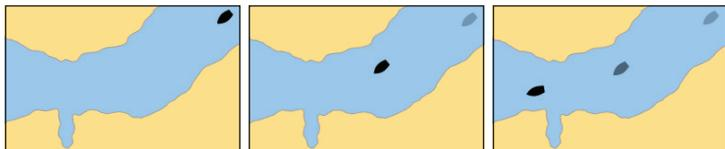
Если выбран режим истинного движения (True), карта остается неподвижной, а изображение судна смещается в истинной проекции относительно неподвижной суши на экране. По мере приближения своего судна к границе экрана изображение карты автоматически смещается, чтобы открыть область впереди судна.
