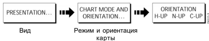
Ориентация карты – это зависимость между картой и направлением движения. Она используется с режимом движения (см. стр. 29) и контролирует зависимость судна и карты друг от друга, а также их отображение на экране. Существует три типа режимов ориентации:
