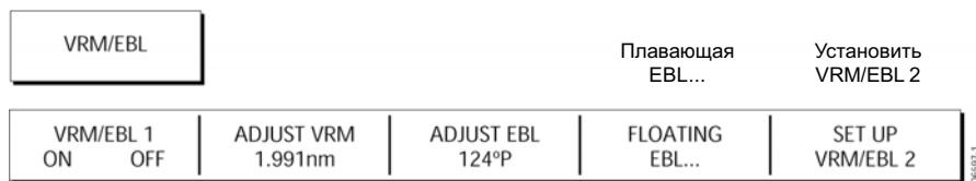
Первые VRM/EBL помещаются на расстоянии 1/3 текущей дальности и 030° относительно носа судна. Если эта настройка установлена, она будет сохранена в дисплее до следующего включения VRM/EBL.
