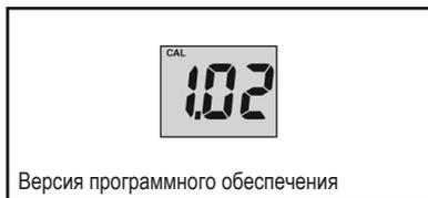
2. Запишите номер версии программного обеспечения, затем нажмите одновременно и удерживайте в течение примерно 2 секунд кнопки `disp` и `true/app`, что вернет устройство в обычный режим работы.
