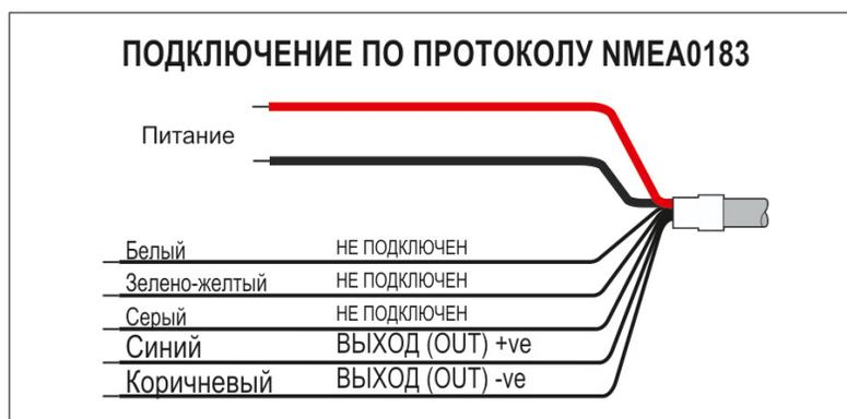
**Примечание:** Конструктивной особенностью приемника RX100 предусмотрена возможность работы в разных форматах передачи данных. Для изменения режима работы производится подключение проводов обмена данными к соответствующим клеммам внутри вычислительного модуля. Убедитесь, что внутри вычислительного модуля провода обмена данными подключены в соответствии с необходимым режимом работы приемника.
