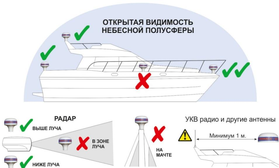
**Установка антенны на плоскую поверхность:**
