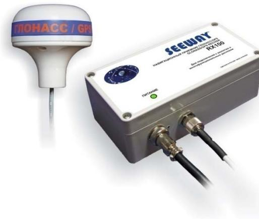
Основными элементами приемника RX100 являются Вычислительный Модуль и внешняя активная Антенна. Антенна устанавливается на открытом месте и подключается к Вычислительному Модулю поставляемым в стандартной комплектации кабелем. Антенна выполнена во влагозащитном корпусе в соответствии со стандартом IPX7. Вычислительный Модуль устанавливается в закрытом от попадания воды месте и подключается к навигационной системе кабелем передачи данных.
